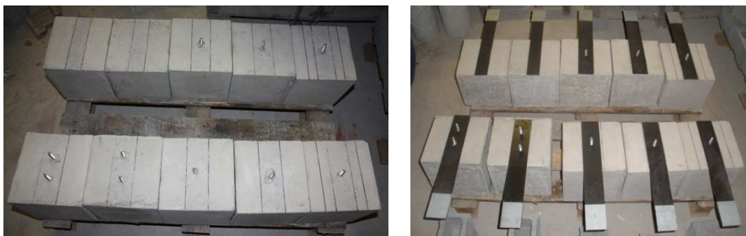
Figura 4. (a) Aspecto dos provetes após aplicação das ancoragens; (b) Aspecto dos provetes após aplicação do MDL-CFRP.
