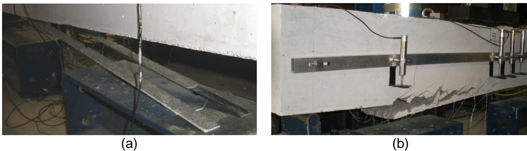
Figura 5 – Modo de rotura do laminado UD-CFRP: (a) Viga reforçada com a técnica EBR; (b) Viga reforçada com a técnica NSM.
